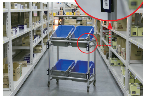
③ STOCタグを用いたマルチオーダーピックカート
