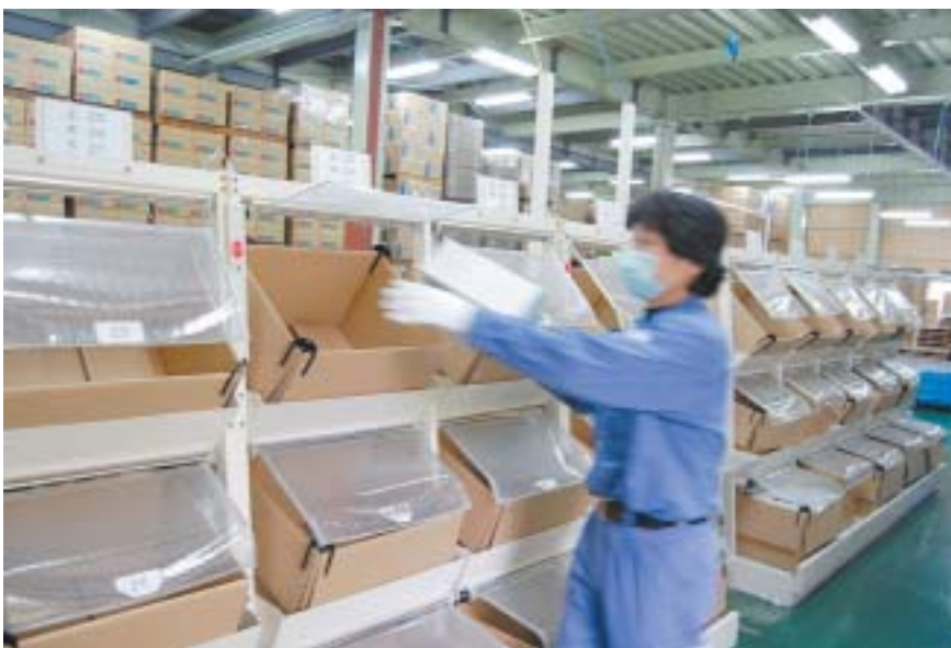
GASは次に仕分けする商品の棚部ゲートが開くため、直感的な作業が実現する
